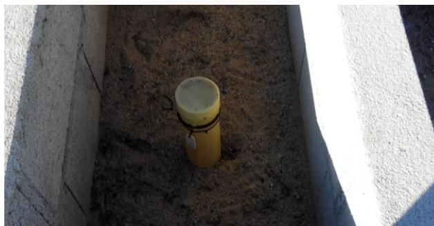
Fig.10 - Aspecto de um inclinómetro. (inclinómetro I3).
