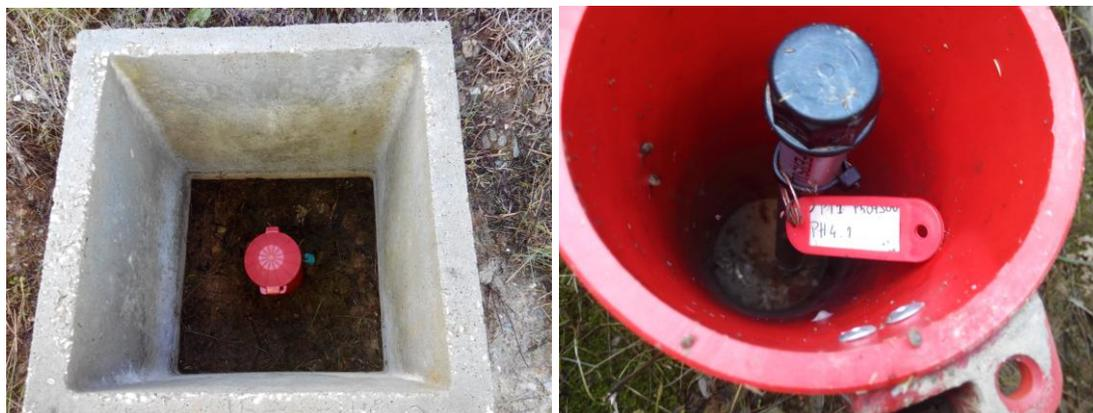
Fig.5 - Aspecto geral de um piezómetro simples. Piezómetro PH4.1.
