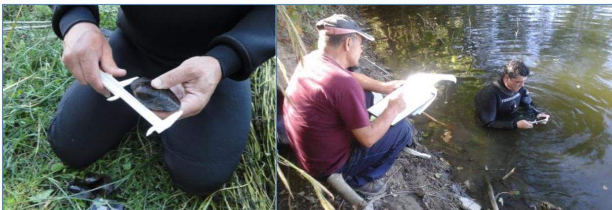
**Foto 7.5 – Ilustração dos processos de Identificação e medição do comprimento máximo dos bivalves**
