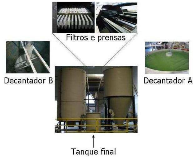
Figura 4 – Equipamento de decantação das águas residuais.
