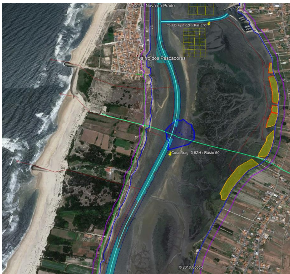
Figura 4 – Vista aérea da região dos trabalhos de dragagem na 2ª linha do Canal de Mira. Indicação das zonas de dragagem, cotas de dragagens (pinos amarelos: 1,0 ZH, junto à povoação Costa Nova do Prado; -0,5 ZH a sul do Bairro dos Pescadores) e linhas de deposição dos dragados (seta vermelha central)
