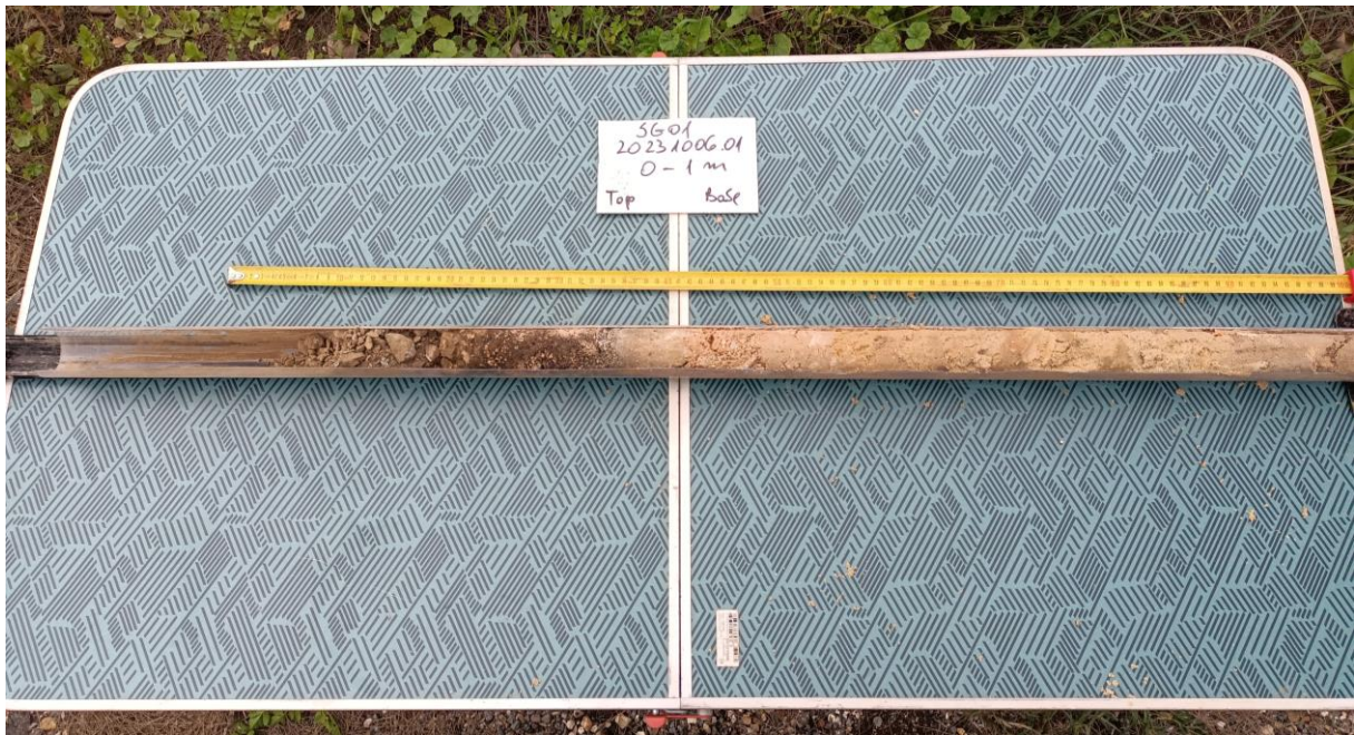
Figura 1 – Aspeto da sondagem SG01 (0 – 1 metro).
