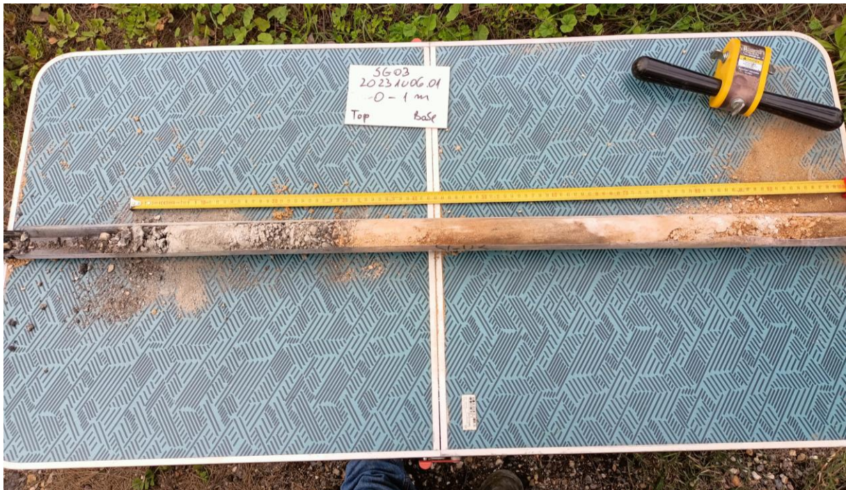
Figura 3 – Aspeto da sondagem SG03 (0 – 1 metro).
