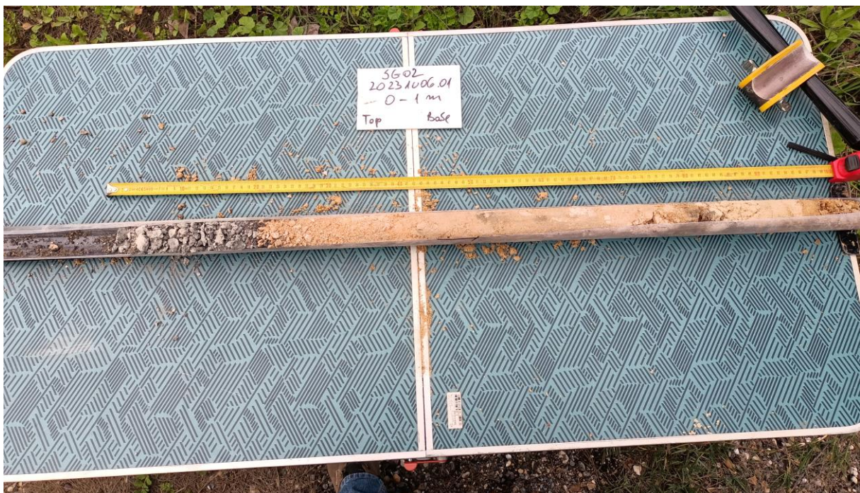
Figura 2 – Aspeto da sondagem SG02 (0 – 1 metro).
