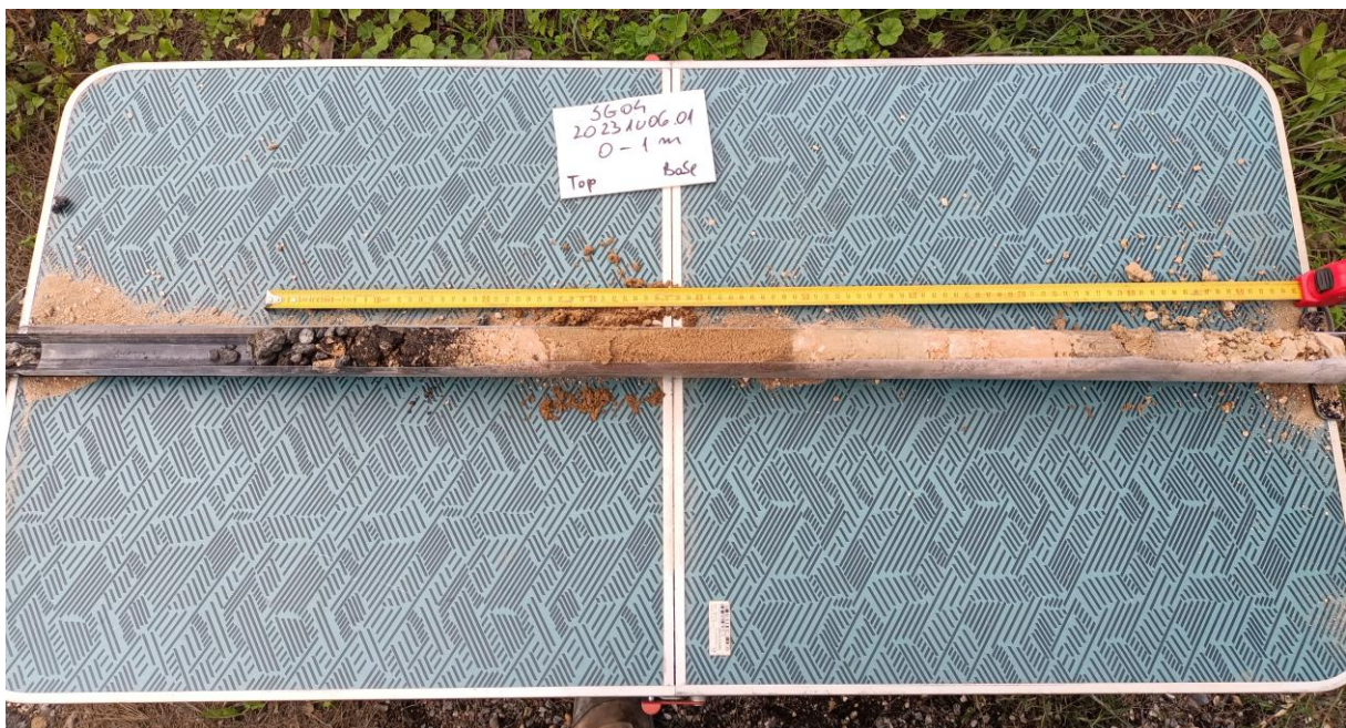
Figura 4 – Aspeto da sondagem SG04 (0 – 1 metro).
