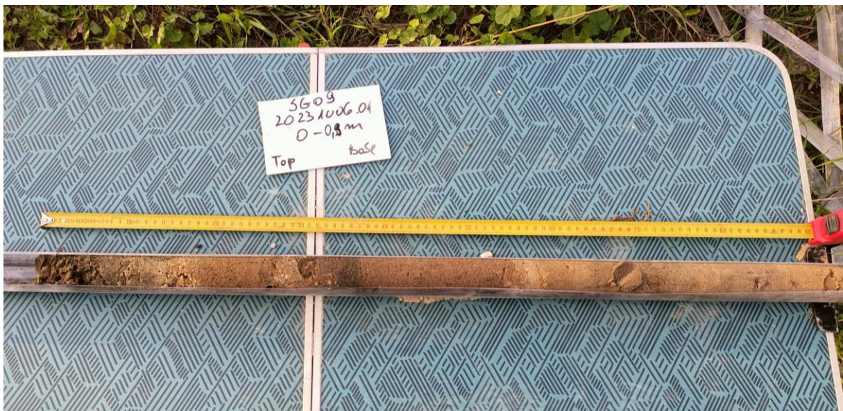
Figura 8 - Aspeto da sondagem SG09 (0 – 0.9 metros).
