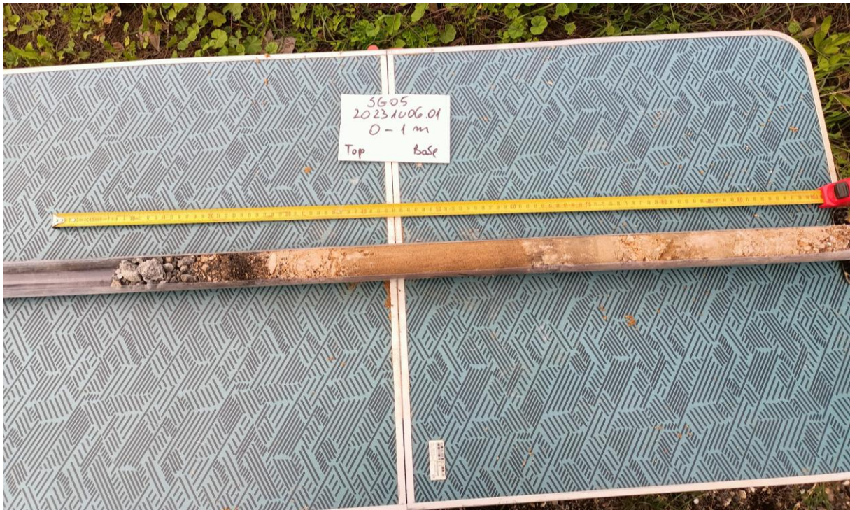
Figura 5 – Aspeto da sondagem SG05 (0 – 1 metro).
