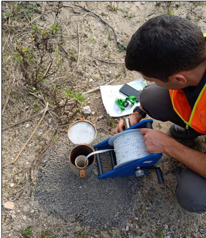
*Figura 2: Aferição do Nível freático em piezómetro*
