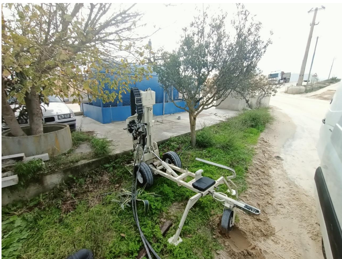
Figura 5 – Equipamento usado na execução das sondagens.
