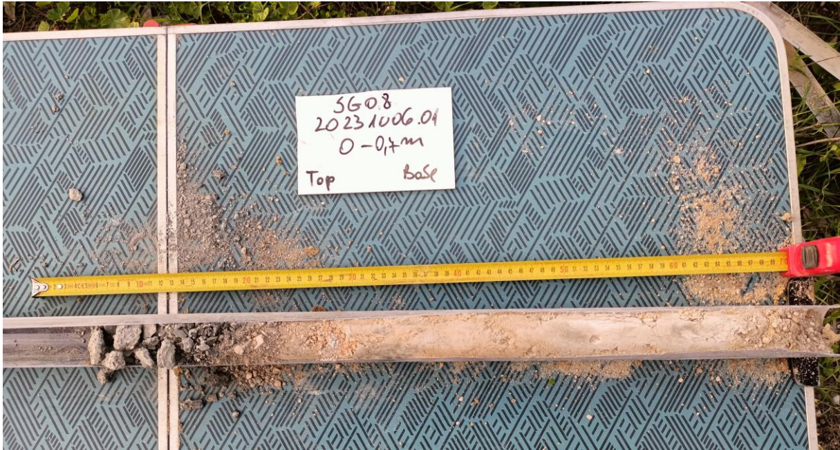
Figura 7 – Aspeto da sondagem SG08 (0 – 0.7 metros).
