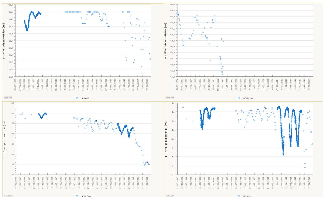
**Figura 4-10. Evolução temporal dos níveis piezométricos nos furos de monitorização da rede SNHIR 484/8, 458/28, 476/20 e 472/21 (informação disponível no site do SNHIR <https://snirh.apambiente.pt/> e conforme localização indicada na Figura 3-2)**
