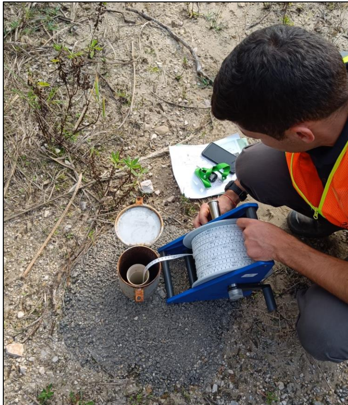
Figura 2: Aferição do Nível freático em piezómetro
