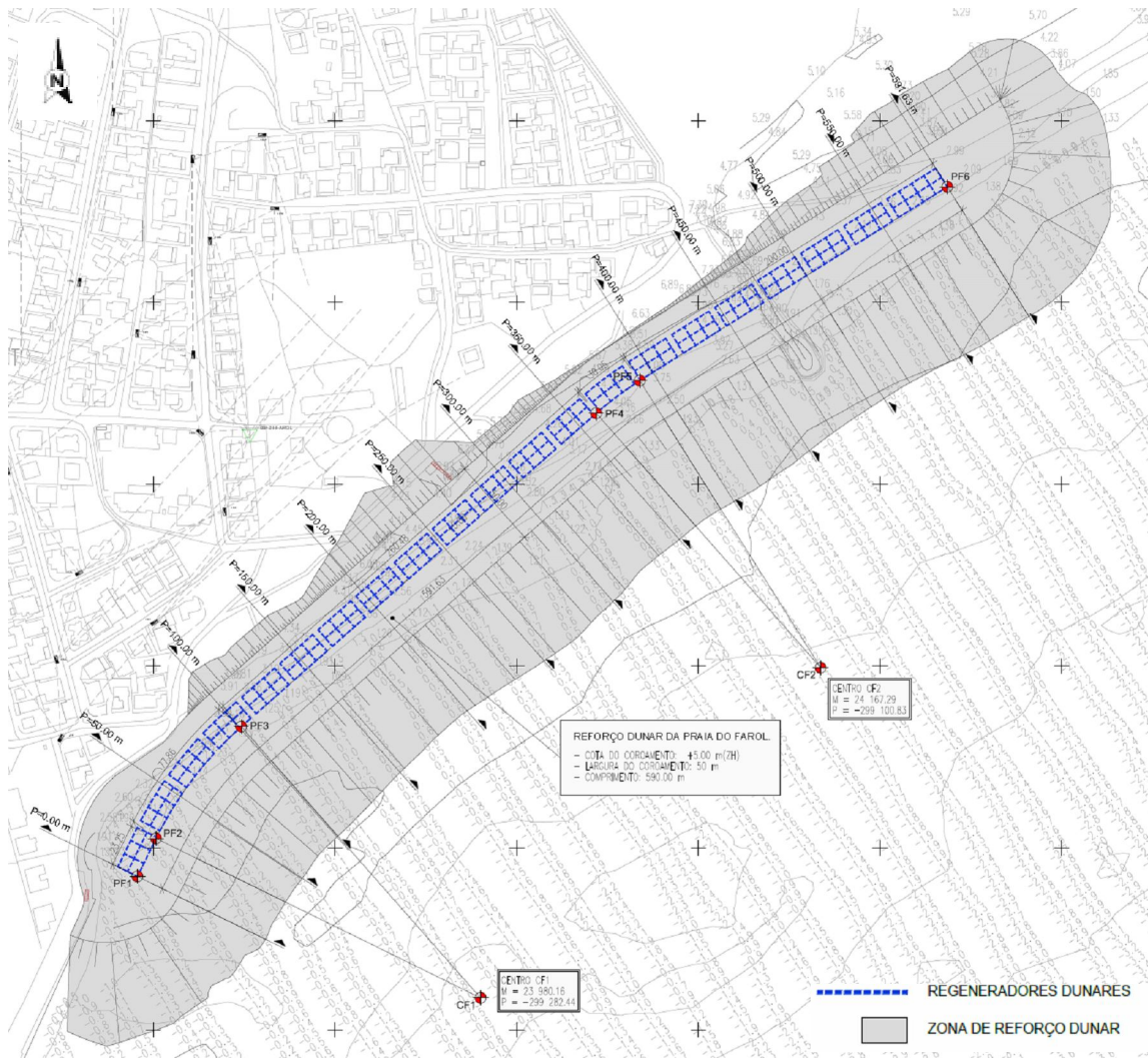
Figura 2 - Esquema da área de depósito para o reforço do cordão dunar da praia do Farol.
