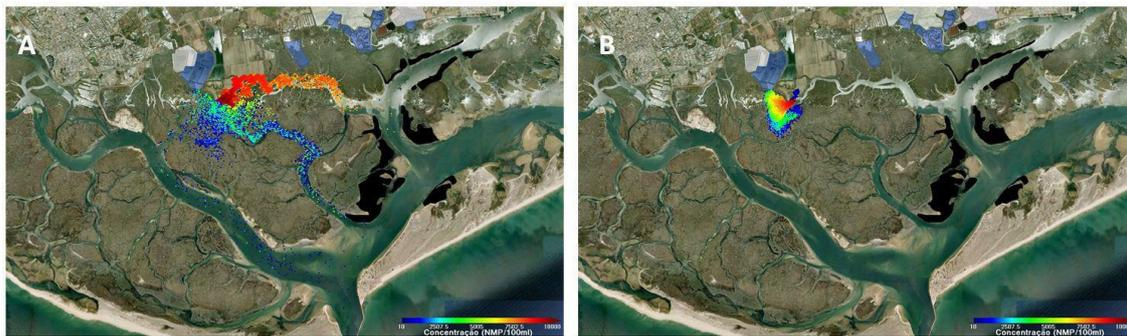
Figura 3.13 - Pluma Microbiológica obtida no período de maré viva. Concentração da descarga igual a  $1 \times 10^4$  NMP/100 ml. A) Condições de baixa-mar e noite; B) Condições de preia-mar e dia.
