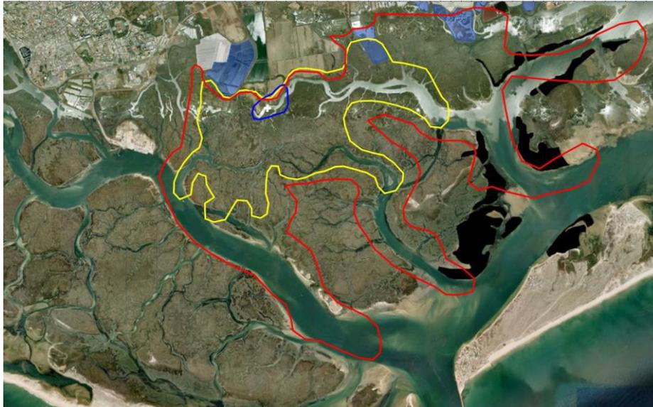
Figura 3.23 – Zona de mistura estimada para a descarga em situação de maré viva. Azul - concentração na descarga de 300 NMP/100 ml; Amarelo - concentração na descarga de  $2 \times 10^3$  NMP/100 ml; Vermelho - concentração na descarga de  $1 \times 10^4$  NMP/100 ml.
