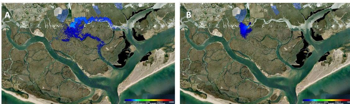
Figura 3.14 - Pluma Microbiológica obtida no período de maré viva. Concentração da descarga igual a  $2 \times 10^3$  NMP/100 ml. A) Condições de baixa-mar e noite; B) Condições de preia-mar e dia.
