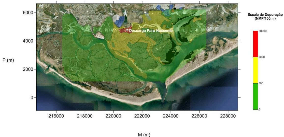
Figura 3.20 – Distribuição espacial da concentração de coliformes fecais em bivalves *Tapes decussatus* para a concentração na descarga de  $1 \times 10^4$  NMP/100 ml. Situação de maré viva.
