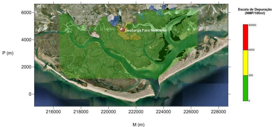
Figura 3.16 – Distribuição espacial da concentração de coliformes fecais em bivalves *Tapes decussatus* para a concentração na descarga de  $1 \times 10^4$  NMP/100 ml. Situação de maré morta.
