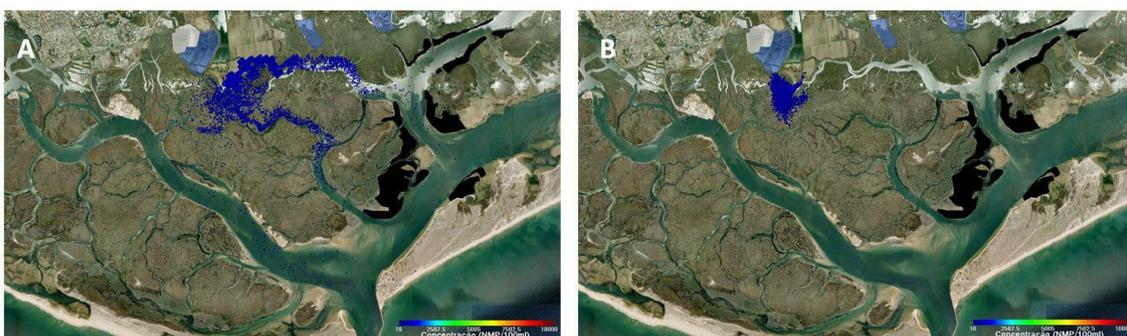
Figura 3.15 - Pluma Microbiológica obtida no período de maré viva. Concentração da descarga igual a 300 NMP/100 ml. A) Condições de baixa-mar e noite; B) Condições de preia-mar e dia.
