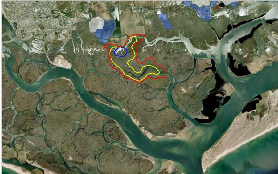
Figura 3.19 – Zona de mistura estimada para a descarga em situação de maré morta. Azul - concentração na descarga de 300 NMP/100 ml; Amarelo - concentração na descarga de  $2 \times 10^3$  NMP/100 ml; Vermelho - concentração na descarga de  $1 \times 10^4$  NMP/100 ml.
