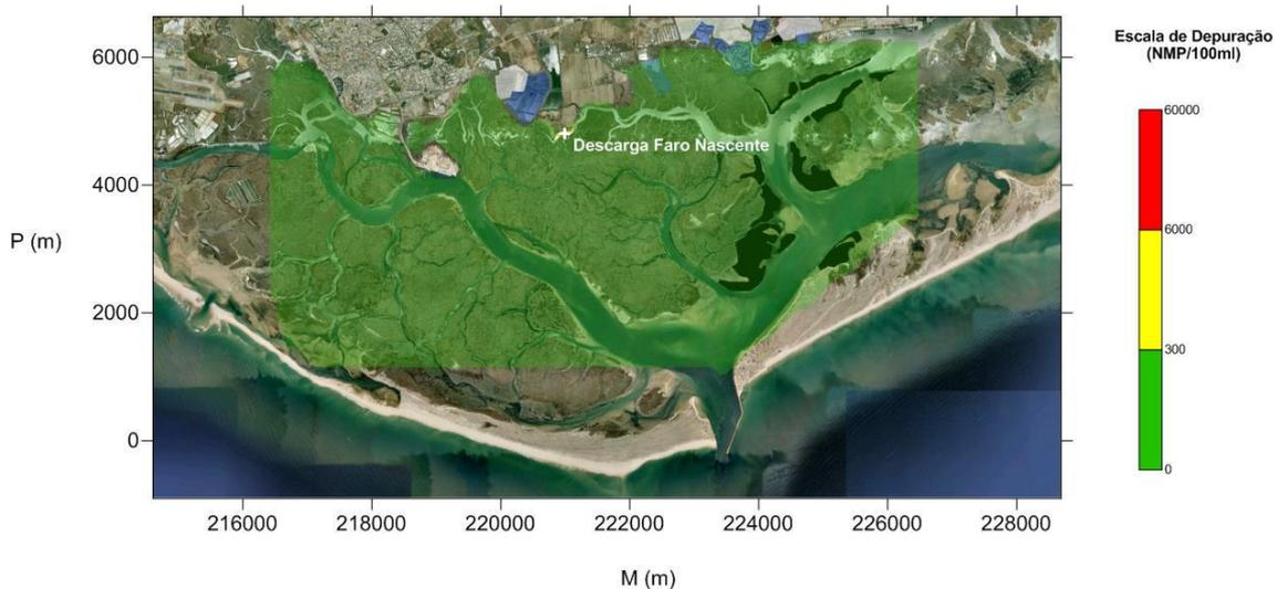
Figura 3.22 - Distribuição espacial da concentração de coliformes fecais em bivalves *Tapes decussatus* para a concentração na descarga de 300 NMP/100 ml. Situação de maré viva.
