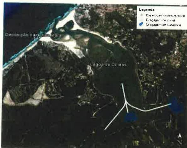
Para o efeito, será necessária a utilização de 2 estações de bombagem intercalares e uma terceira na praia para lançamento por aspersão (rainbow) para a deriva litoral. O equipamento será instalado acima do nível de preia-mar, e terá um alcance da ordem dos 100m, pelo que os sedimentos serão depositados na zona de praia sempre imersa.
