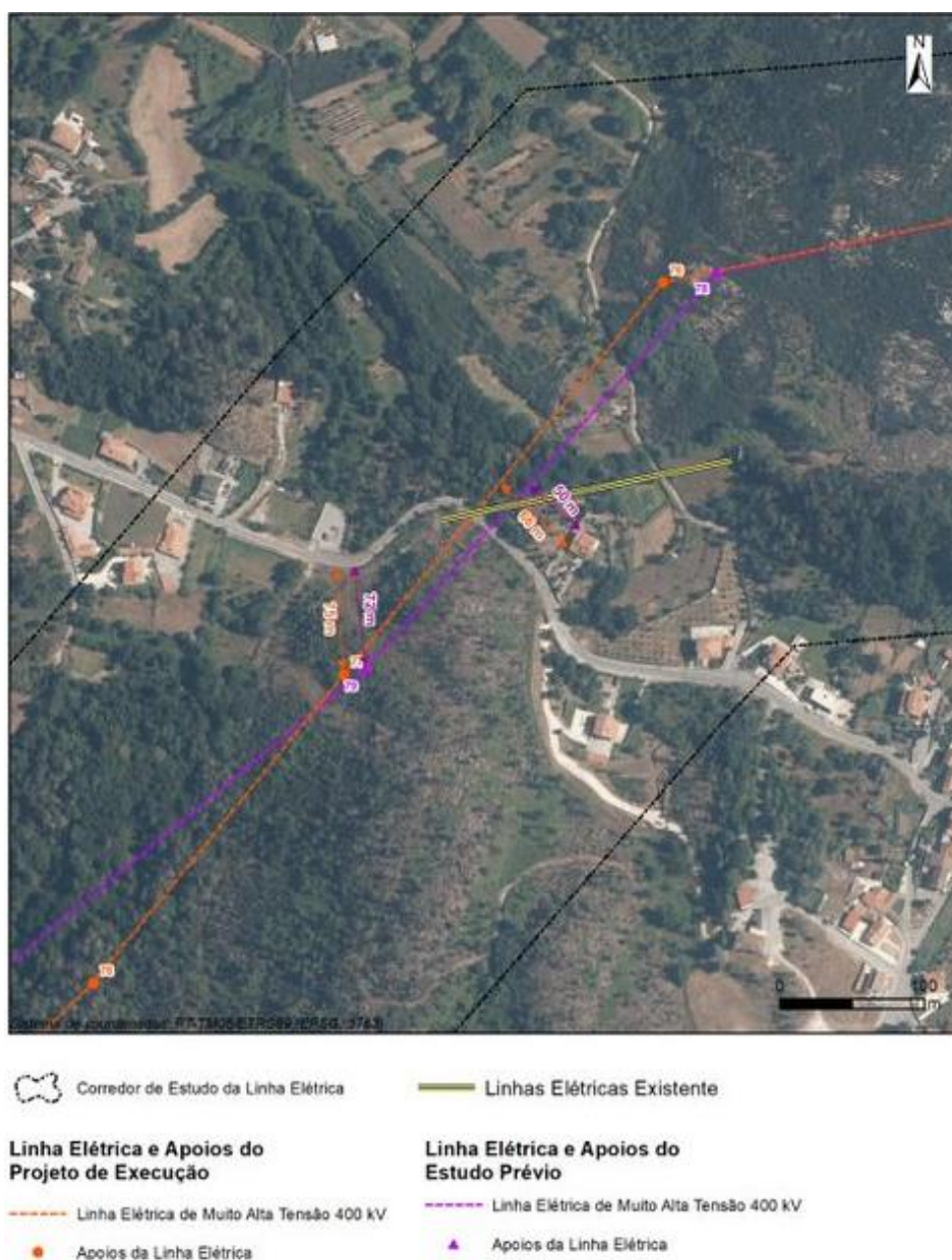
Figura 4.43 – Ripagem do vão AP76-AP77 para noroeste, assegurando 66 m de afastamento à habitação mais próxima.
