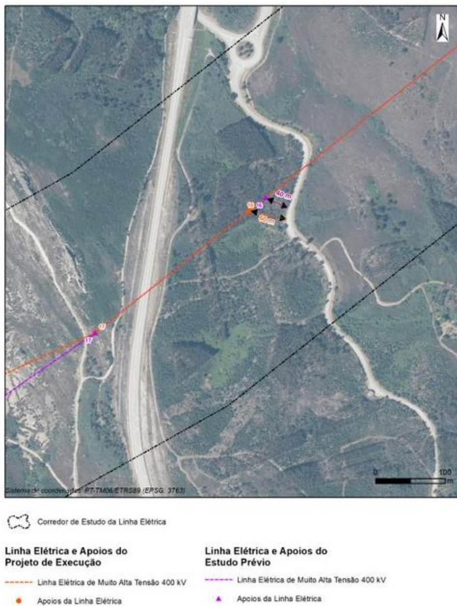
Figura 4.33 – Ajuste do apoio AP16 para sudoeste, assegurando 60 m de afastamento à M574.
