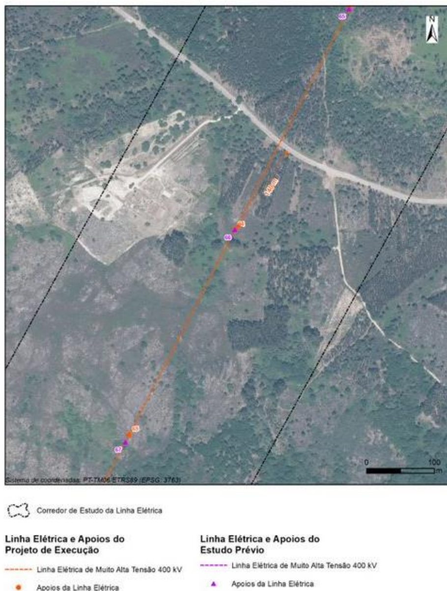
Figura 4.41 – Manutenção do apoio AP64, dada a distância já assegurada de 140 m ao acesso e à extensão do vão AP63-AP64 já no seu limite.
