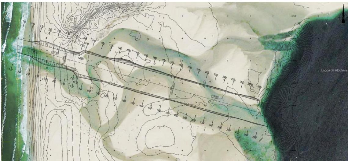
**Figura 8 – Abertura da barra de maré e estabelecimento do canal tendo por base o levantamento topo-hidrográfico de 2017 (localização a aferir aquando da execução da intervenção)**
