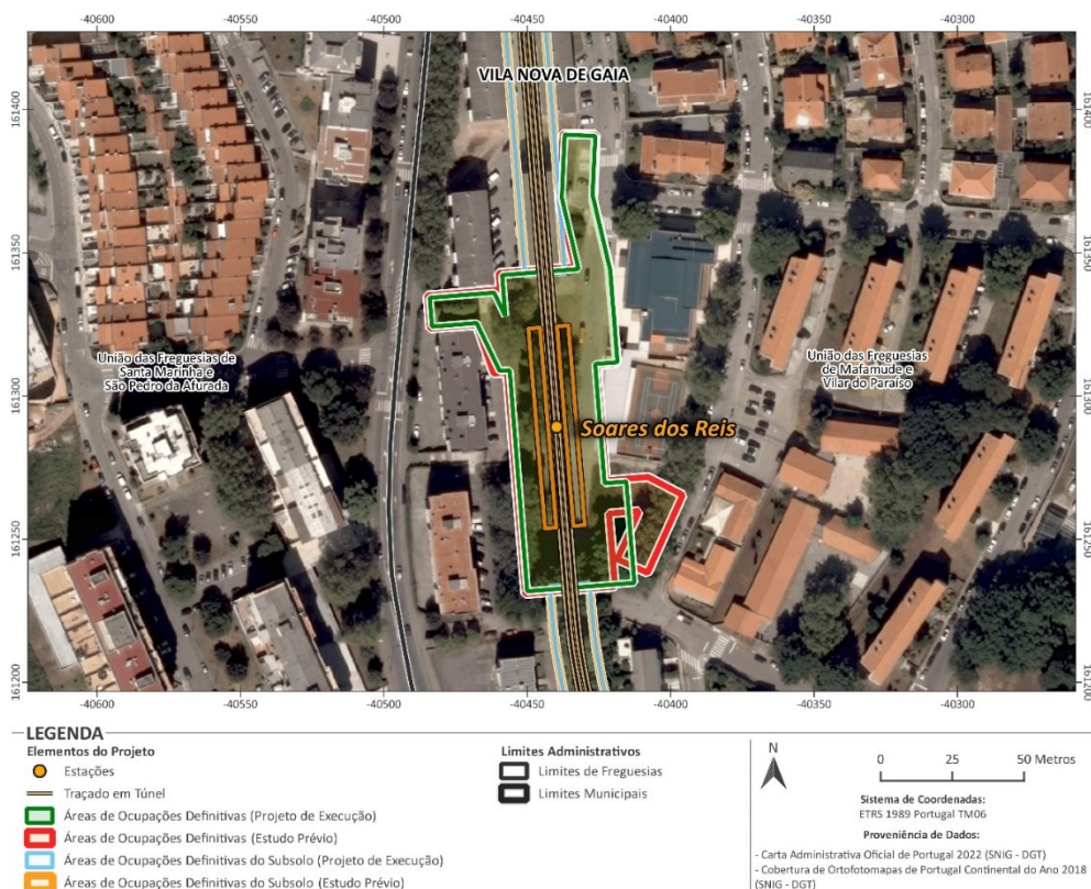
Figura 6.22 – Carta de comparação entre a área de ocupação definitiva prevista durante a fase de projeto de EIA e a atual fase de execução do projeto para a estação Soares dos Reis da Linha Casa da Música – Santo Ovídio
