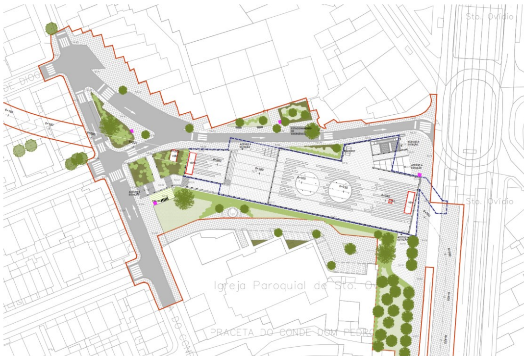
Figura 6.51 - Estação Santo Ovídio – Planta de inserção urbana (a vermelho está representado o limite da área de intervenção).
