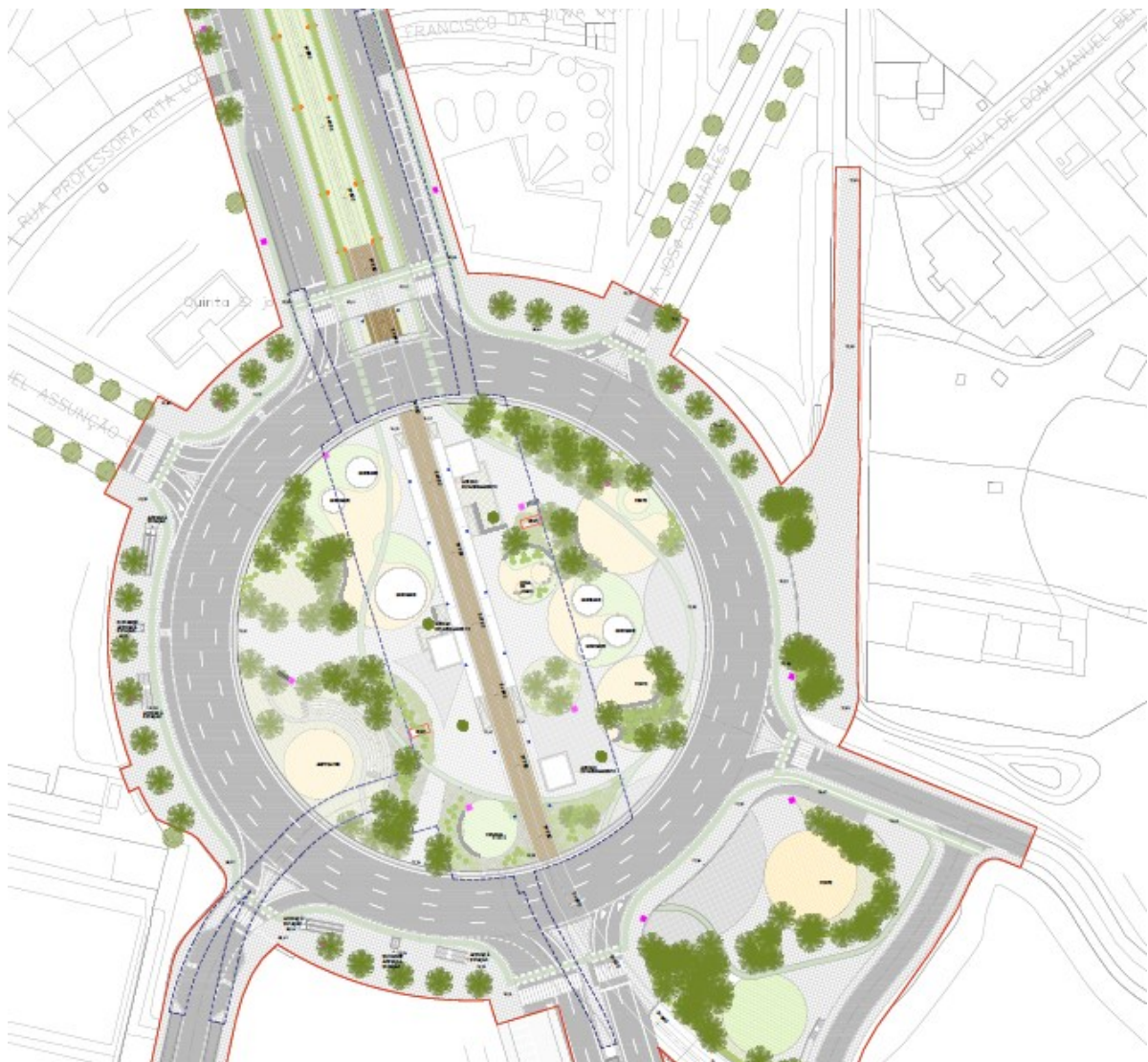
Figura 6.46 - Estação Rotunda – Planta de inserção urbana (a vermelho está representado o limite da área de intervenção e a azul o limite da estação).
