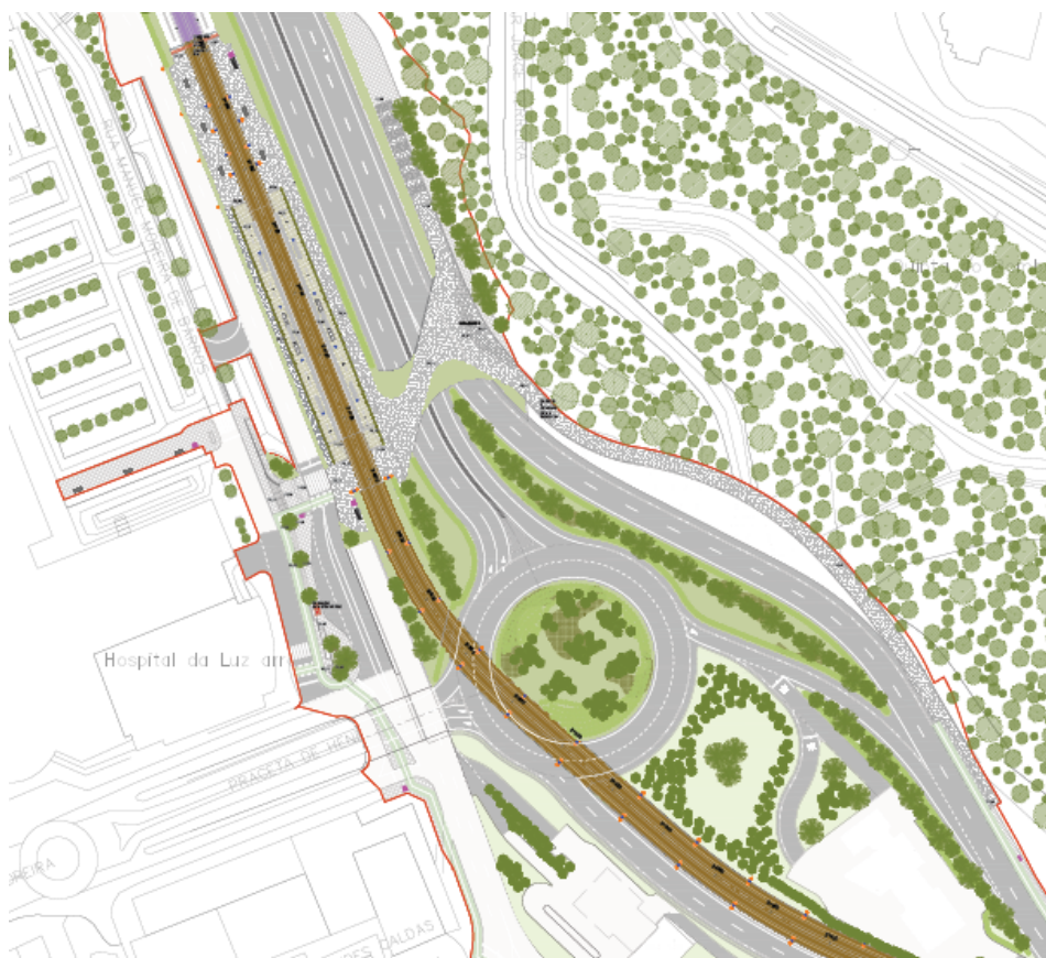
Figura 6.42 - Estação Arrábida – Planta de inserção urbana (a vermelho está representado o limite da área de intervenção).
