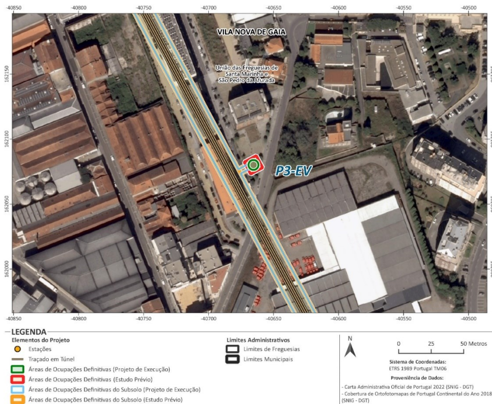
Figura 6.20 – Carta de comparação entre a área de ocupação definitiva prevista durante a fase de projeto de EIA e a atual fase de execução do projeto para o poço de emergência e ventilação n.º 3 (P3-EV) da Linha Casa da Música – Santo Ovídio
