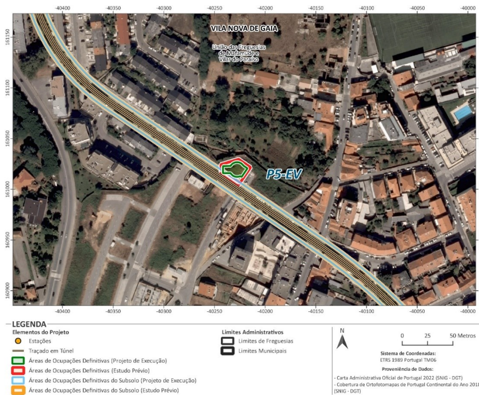
Figura 6.23 – Carta de comparação entre a área de ocupação definitiva prevista durante a fase de projeto de EIA e a atual fase de execução do projeto para o poço de emergência e ventilação n.º 5 (P5-EV) da Linha Casa da Música – Santo Ovídio
