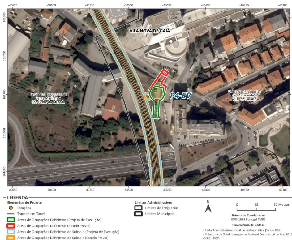
Figura 6.21 – Carta de comparação entre a área de ocupação definitiva prevista durante a fase de projeto de EIA e a atual fase de execução do projeto para o poço de emergência e ventilação n.º 4 (P4-EV) da Linha Casa da Música – Santo Ovídio
