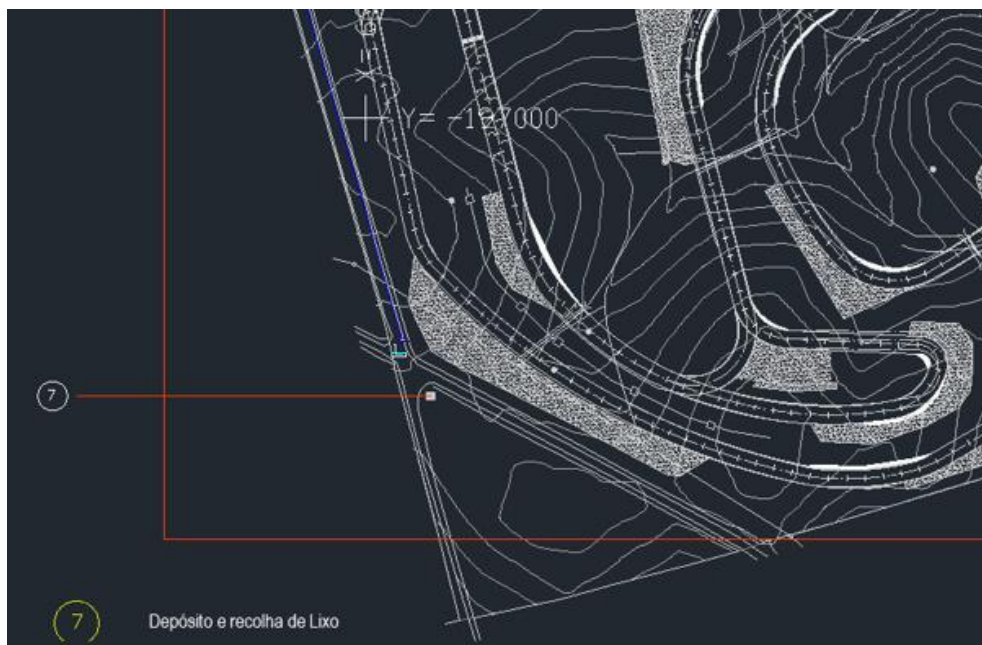
Figura 5.4 – Localização dos 2 contentores com a capacidade de 1100 litros, situados junto da estrada municipal
