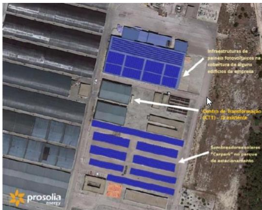
Figura 4: Infraestruturas implantadas de fotovoltaico para autoconsumo.
