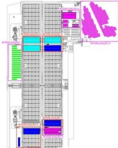
Figura 1: Módulos fotovoltaicos representados a verde – instalação fotovoltaica Fase 1 da UPAC (existente) Módulos fotovoltaicos representados a rosa – instalação fotovoltaica Fase 2 da UPAC (existente) Módulos fotovoltaicos representados a azul – instalação fotovoltaica Fase 3 da UPAC (a instalar)
