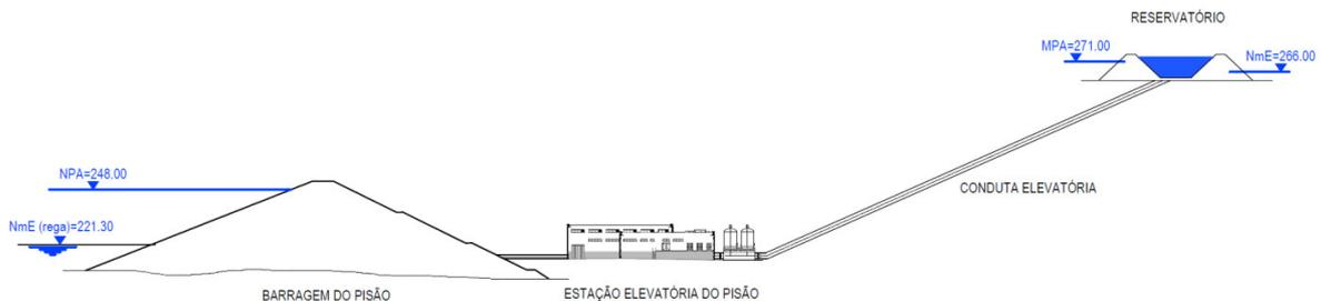
Figura 1 - Esquema do sistema de adução
