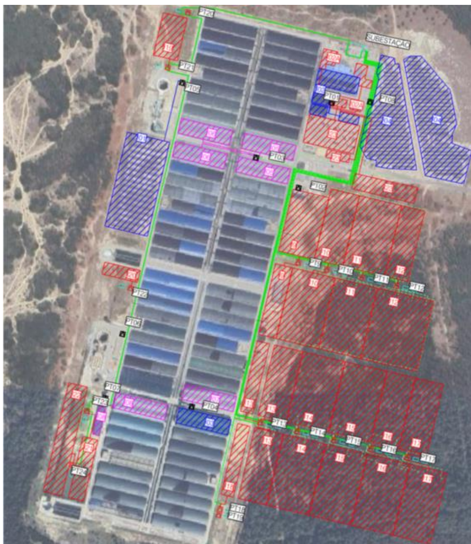
Figura 3.3.9 – Coberturas com painéis fotovoltaicos (Vermelho – UPAC nova Ampliação; Lilás – UPAC inserida em licenciamento já entregue; Azul – UPAC existente e em exploração)
