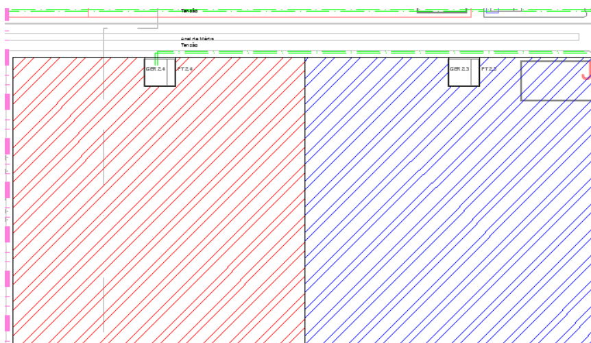
Figura 3.6.21 – Edifício de engorda de linguado J e respetiva localização dos PT's em fase de estudo prévio. As áreas sombreadas procuram representar as respetivas áreas de influência dos PTs.
