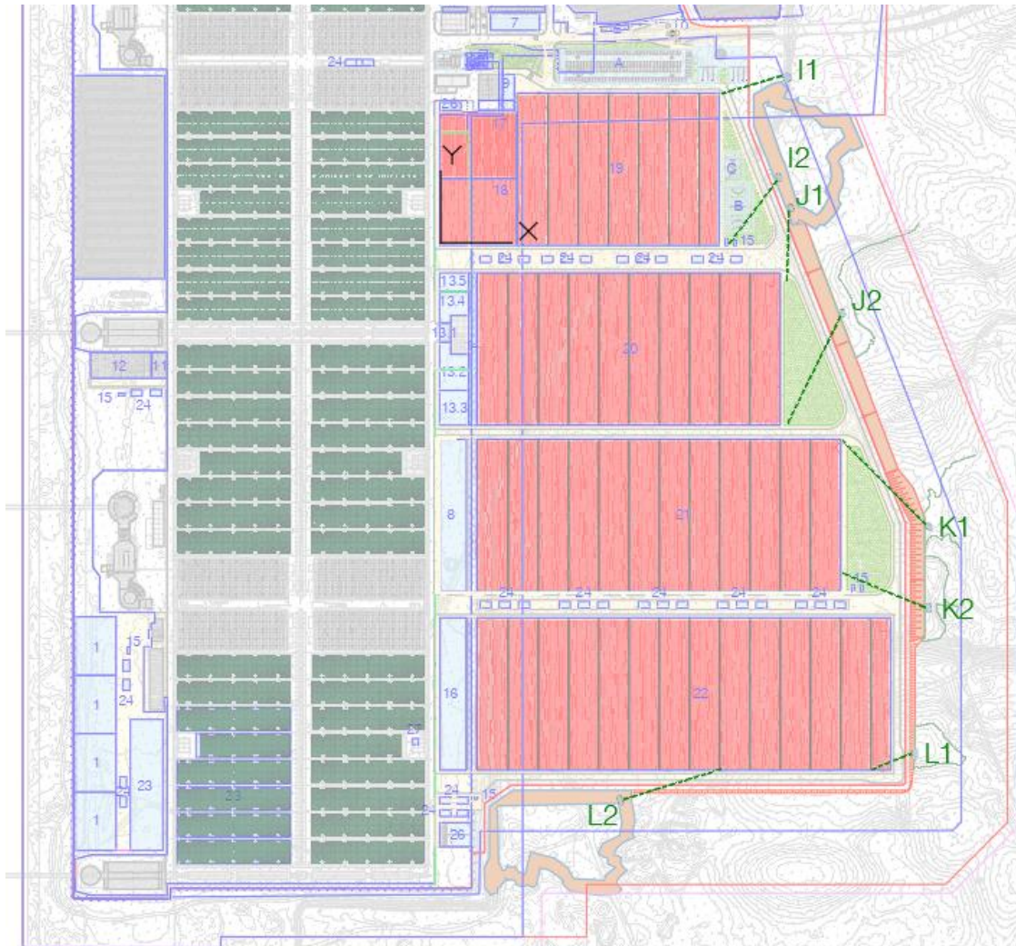
Figura 4.5.3 - Localização das zonas de descargas na vala das dunas dos edifícios novos
