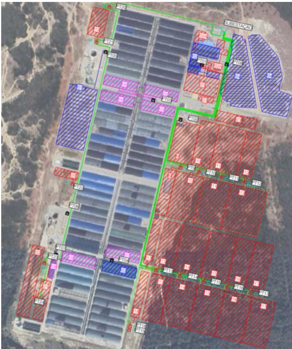
Figura 4.5.49 - Coberturas com painéis fotovoltaicos (vermelho – UPAC nova da ampliação; lilás – UPAC inserida em licenciamento já entregue; azul – UPAC existente e em exploração)
