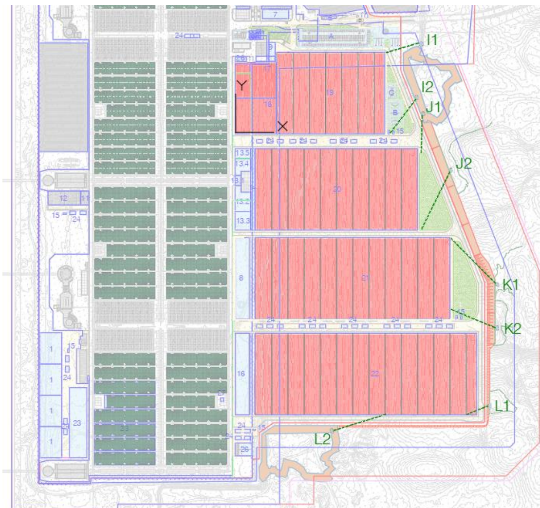
Figura 3.3.12 - Descargas da rede pluvial na “Vala das Dunas”
