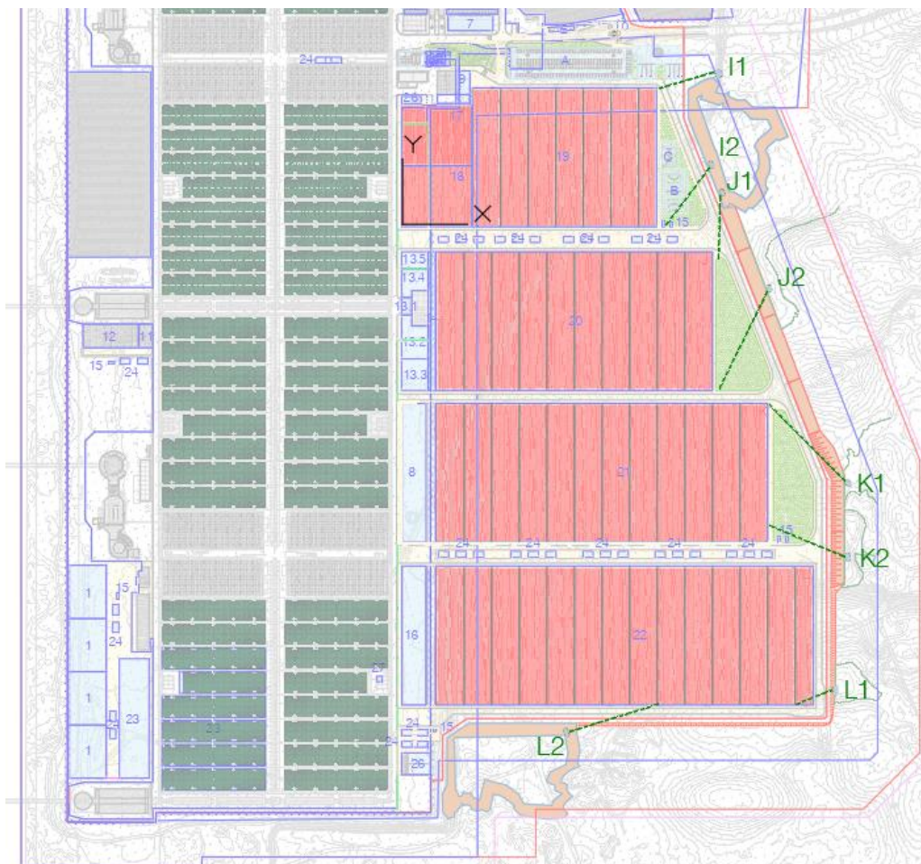
Figura 4.5.2 - Descargas da rede pluvial na “vala das dunas”
