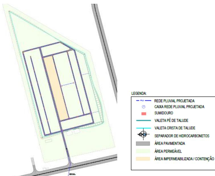
**Figura 55 - Rede de Drenagem de águas pluviais na subestação**
