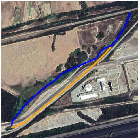
Figura 46 – linha de água original (azul) e desvio construído em 2004 (cor de laranja)
