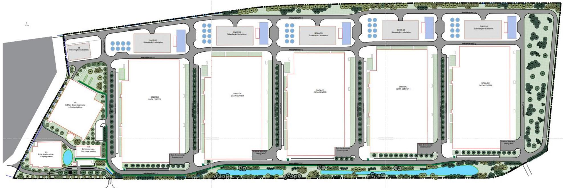
Figura 8 – Acessos e arruamentos internos a construir no interior do Campus (assinalados a cor cinzenta na figura).
