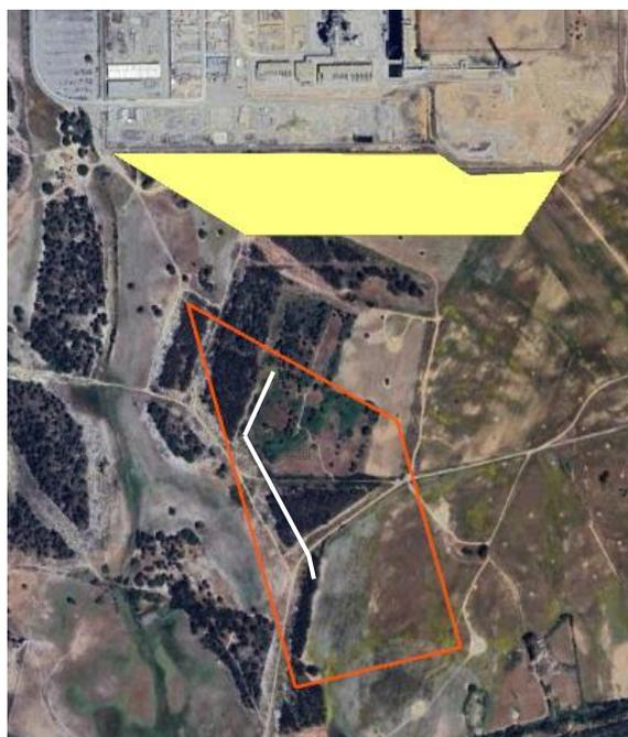
Figura 52 – estruturas de drenagem identificadas em campo (branco) e expansão da refinaria em 2024 (a amarelo).
