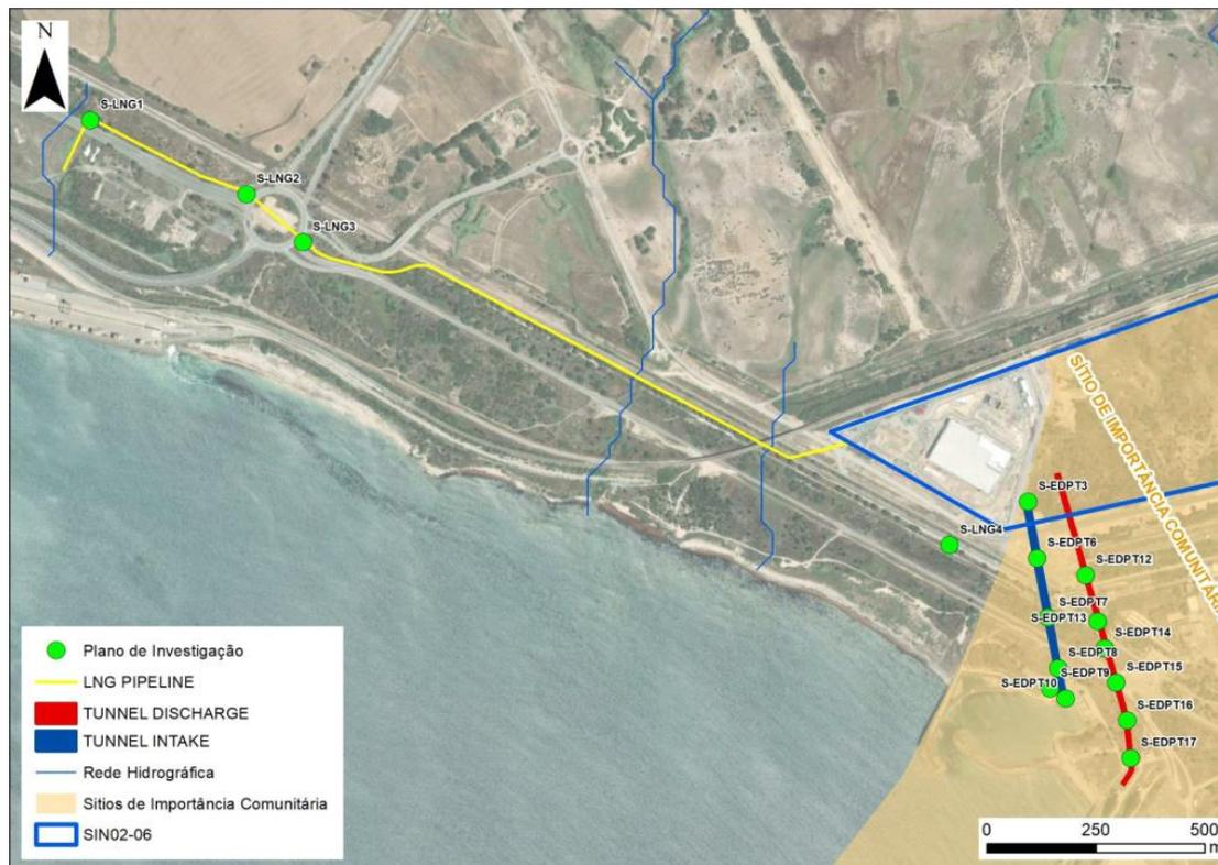
**Figura 97 - Plano de investigação executado na área da Estação de bombagem e respetivas tubagens de adução e descarga.**
