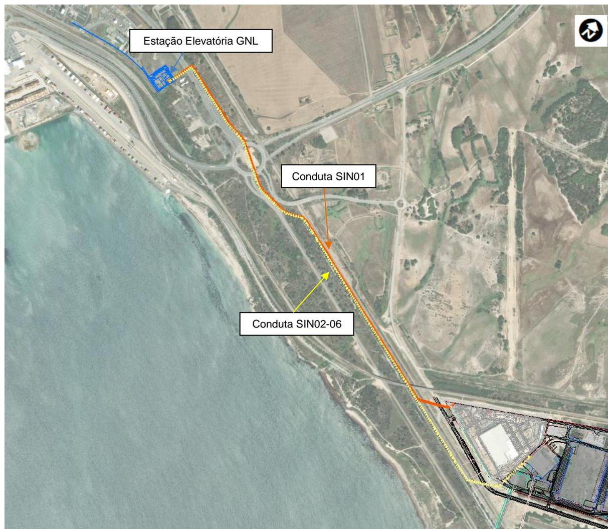
**Figura 18 – Traçado da conduta LNG até ao NEST (SIN01) e REST (SIN02-06).**
