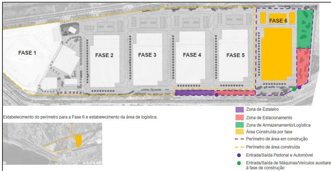
**Figura 82 – Localização dos estaleiros e áreas de apoio de acordo com o faseamento construtivo do Campus do Data Center.**
