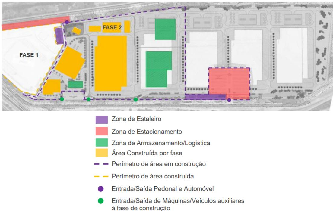
**Figura 101 – Área a desmatar no início da obra de construção do SIN02 (assinalada a roxo como “Perímetro de área em construção”).**
