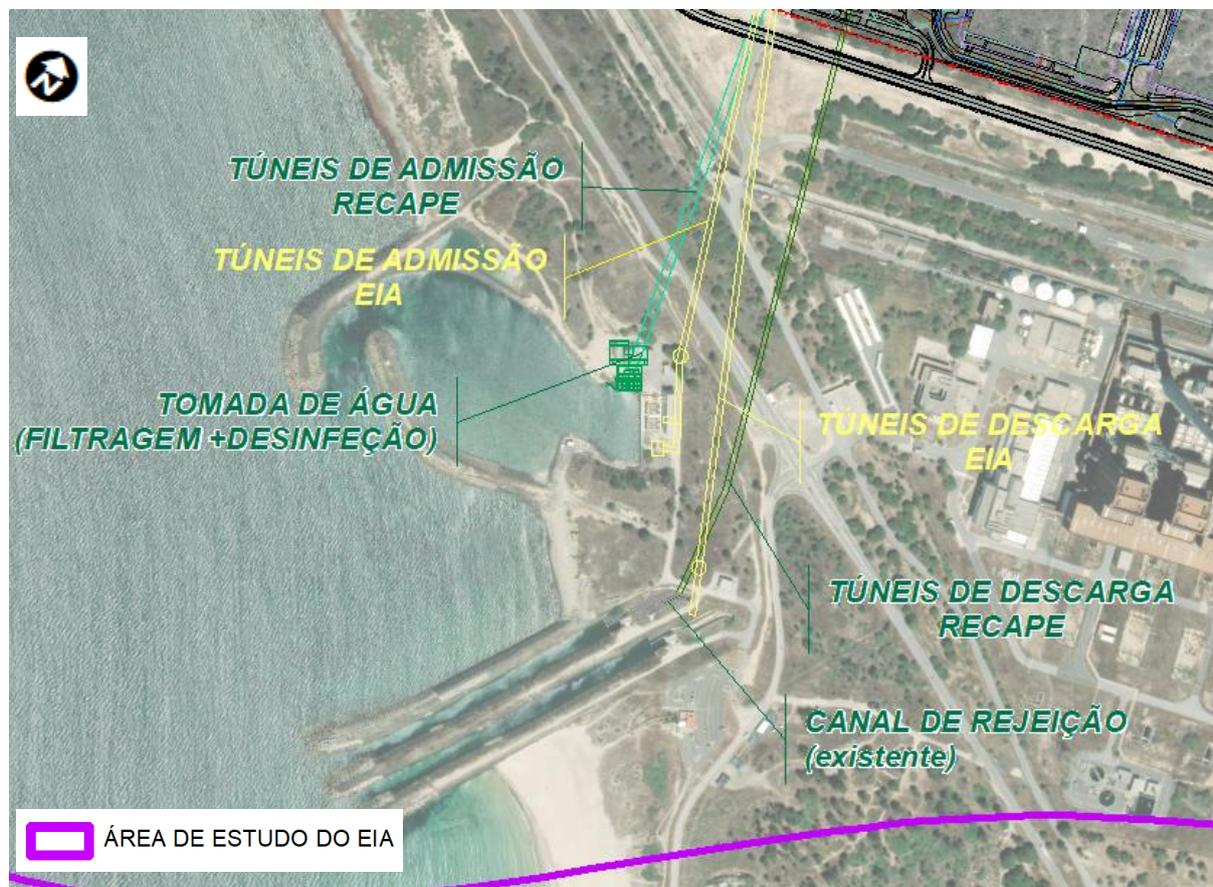
Figura 68 – Ajuste do Traçado dos Túneis de entrada/descarga de água do mar.
