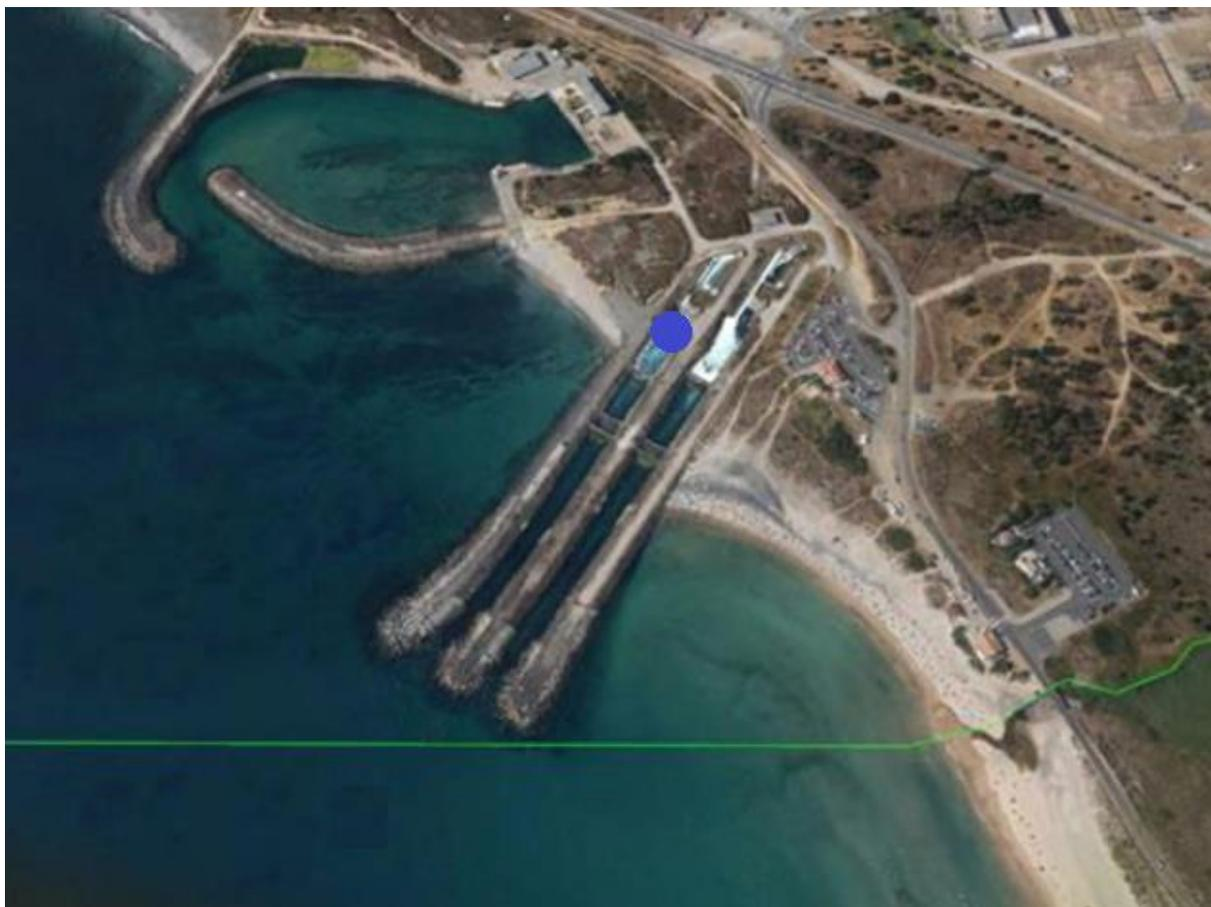
**Figura 1 - Saída da água de rejeição do sistema de refrigeração do Projeto NEST e Sin02-06 e proposta de localização do ponto de amostragem (a azul) para monitorização cloro e pH.**
