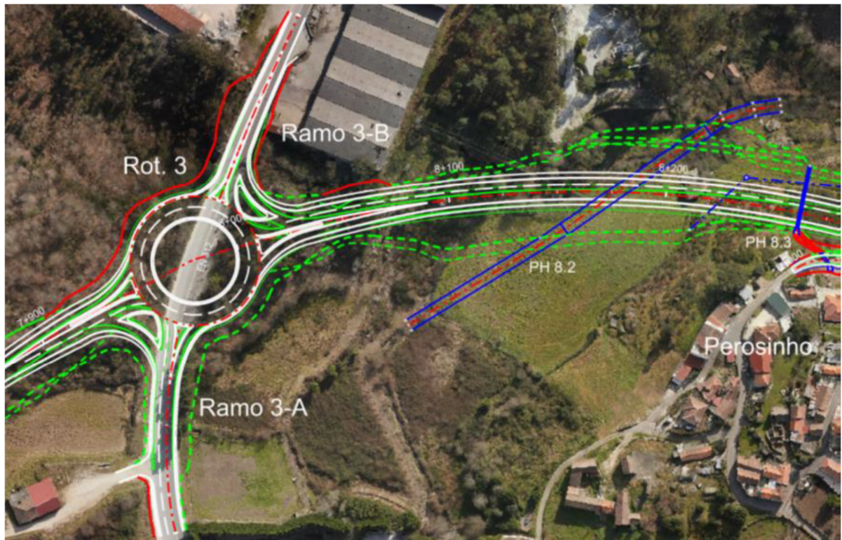
Figura 8 - Travessia da ribeira das Lajes em aterro, entre km 8+000 e km 8+300 (traçado do Estudo Prévio representado a verde)
