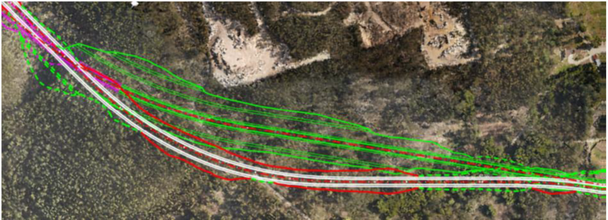
Figura 5 - Desvio do traçado entre o km 3+500 e o km 4+225 para reduzir a escavação (traçado do Estudo Prévio representado a verde)
