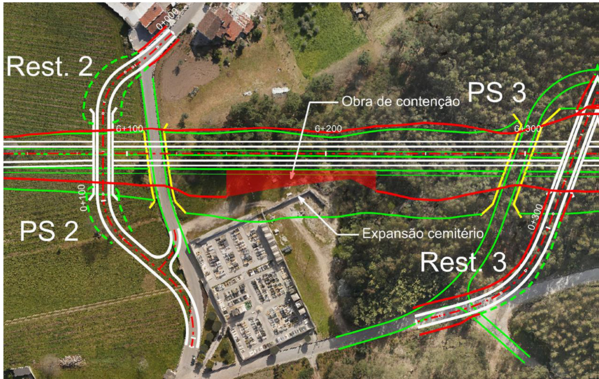
Figura 7 - Ripagem do eixo na zona do cemitério de Cabeça Santa e da sua ampliação (traçado do Estudo Prévio representado a verde com as OA's a amarelo)
