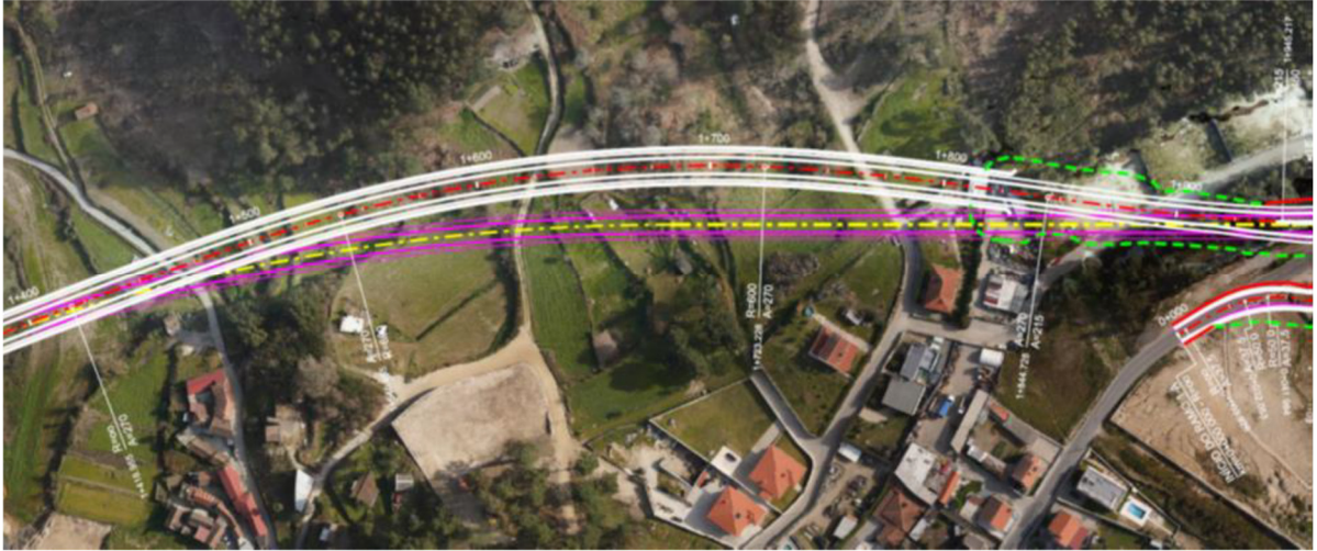
Figura 3 -Ripagem do traçado entre o km 1+400 e o km 2+050) (traçado do Estudo Prévio representado a magenta)
