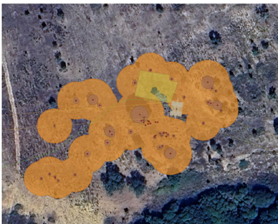
Figura 4. Imagem gerada em ambiente de trabalho de SIG relativa às envolências do apoio identificado P105, aqui referido a título de exemplo. Área de trabalho identificada a amarelo incluída na área de povoamento (laranja) ladeada pelos exemplares de sobreiro (raio de copas a castanho). Conforme relatado se o apoio for movido para norte deixará de entrar em conflito com a área de povoamento, assim como a área de trabalho.
